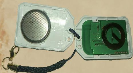
②2つに裂けるので電池のプラスとマイナスの向きを間違えないように入れてから、①の逆にスライドして分割した子機を1つにして下さい。
