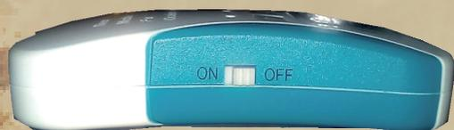
①探索機の電源が OFF（電源切）になっている事を確認して下さい。
