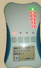
2機目の子機も使いたい場合も探知機と子機の間を 1.5 メートル以上開けて探知機の電源を入れて、2のボタンを軽く1回押して、しばらく待ちます。
